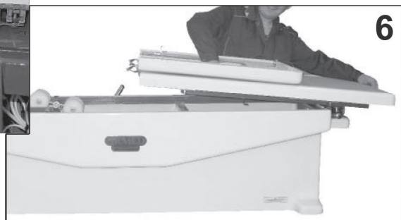
Фото 8. Снятие секций кушетки при техническом обслуживании
